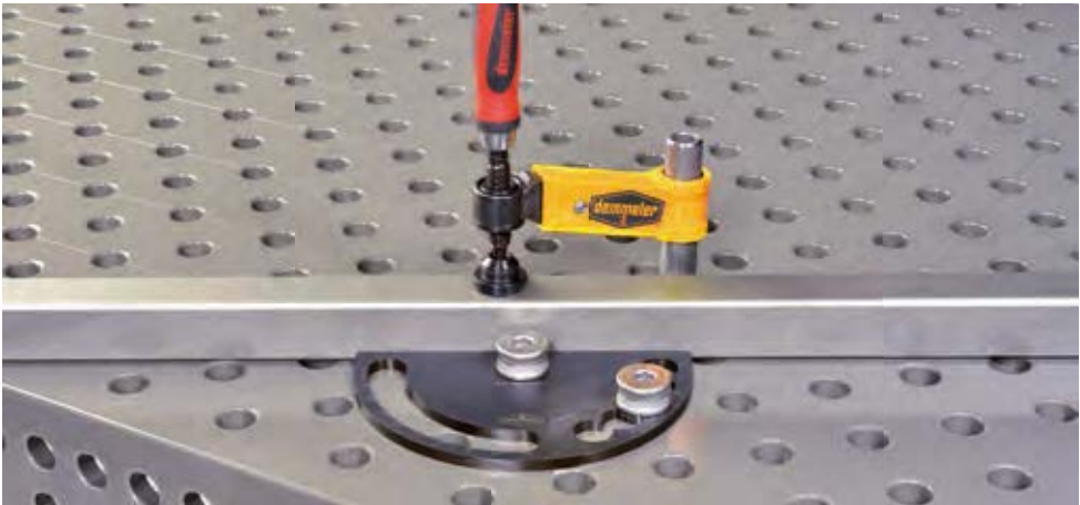
Se puede encajar de forma en pasos de 15° (0° - 60°) y de forma continua 0° - 90°
